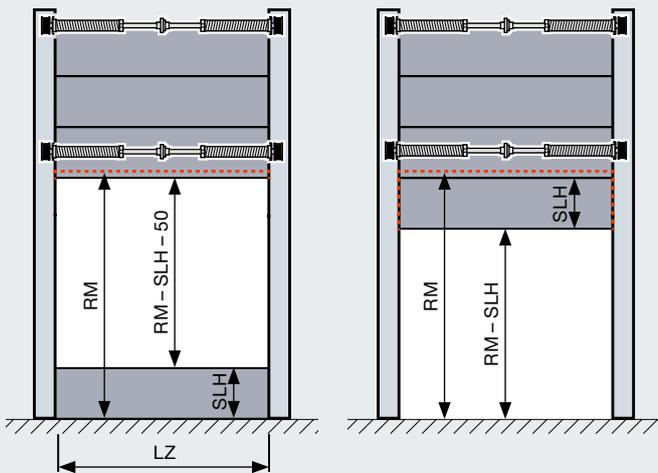
Lorsque la porte couplée est ouverte (illustration de droite), le socle à rainures s'immobilise avec la rampe d'exploitation dans la partie supérieure de la baie.
