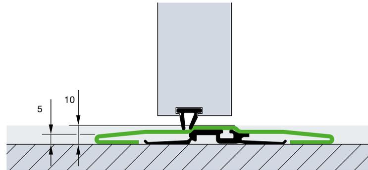
Le seuil en acier inoxydable s'élève à 10 mm au milieu et à 5 mm sur les bords. Un seuil renforcé plat d'env. 13 mm est livré pour les portes à partir d'une largeur de 5510 mm et pour les portes avec verre véritable à partir d'une largeur de 4510 mm. **Pour les portes avec verre véritable dans la zone du portillon incorporé à partir d'une largeur de porte de 4510 mm !**
