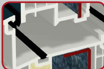
Le joint central de la feuillure de dormant contribue fortement à l'amélioration de l'isolation thermique. Il protège aussi les ferrures des infiltrations d'humidité et améliore ainsi l'effort à l'ouverture en particulier par basses températures. La S 9000 est aussi disponible en version à joint de frappe, avec deux barrières d'étanchéité.
