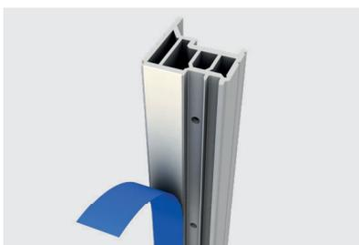
**1** - Le profilé de liaison comporte un ruban d'étanchéité dont les deux faces sont adhésives. Il suffit de retirer le film de protection et de coller le profilé de liaison sur le profilé de la fenêtre.
